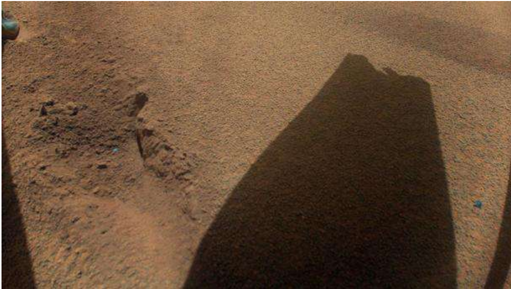
Extremo roto de una de las palas. Imagen NASA/JPL-Caltech
