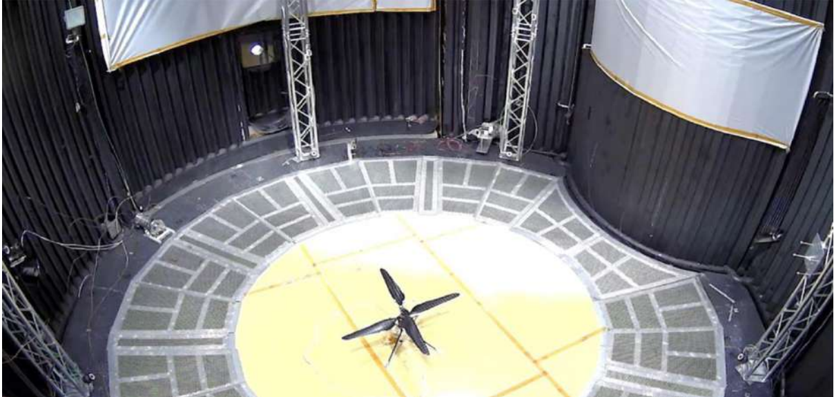
Primer vuelo controlado (el 31 de mayo de 2016) del modelo a escala nominal del prototipo del Ingenuity, ensayado en la cámara térmica de vacío del simulador espacial de JPL. Imagen: NASA/JPL-Caltech
